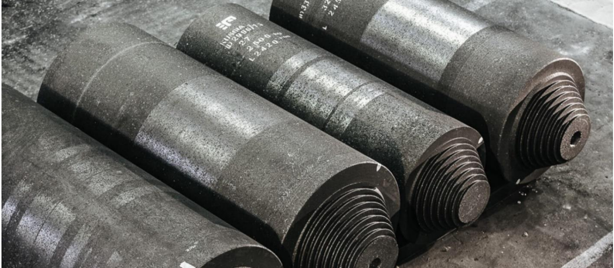
Mynd 1: Forbökun grafitiseruð skaut eins og þau sem verða notuð hjá PCC BakkiSilicon
